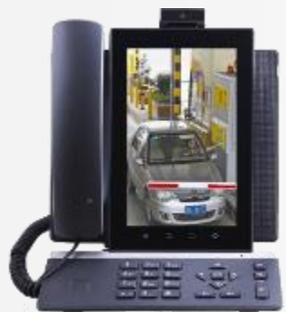
可视对讲服务端 应用场所：各监控操作台
